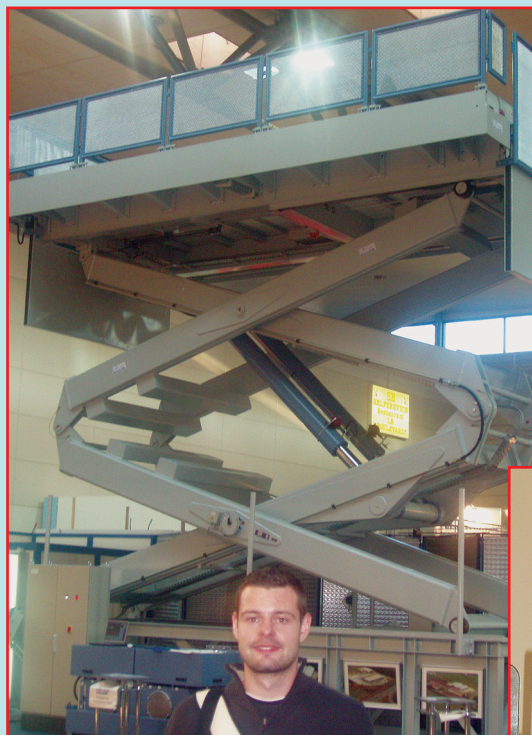
Dvina platforma za prevoz avtomobilov nosilnosti 5000 kg, dimenzije 3000 x 6000 mm
